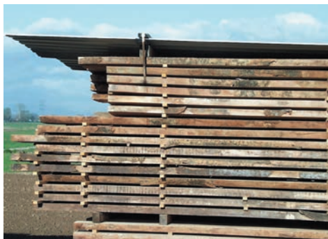
Abdecken der Schnittholzstapel, Bild 1. Einfache Ausführung einer Stapelabdeckung aus Trapezblechen (Pultdach) mit Sturmsicherung. Je nach örtlichen Windverhältnissen muss die Verankerung mit Draht ggf. in niedrigere Brettlagen verlegt werden. Man beachte den Freiraum über der obersten Brettlage des Stapels und die Dachüberstände. Bild: U. Lohmann.
