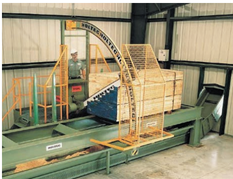
Abkappen, Bild 2. Kappschnitt durch Kettensäge am Bretterpaket, erster Schnitt vor dem Ablängen. Bild: Holtec.
