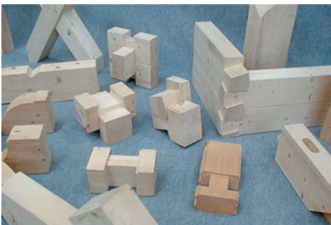
Abbundmaschinen, Bild 3. Beispiele für die vielfältigen Bearbeitungsmöglichkeiten von A. Bild: Hundegger, Hawangen.
