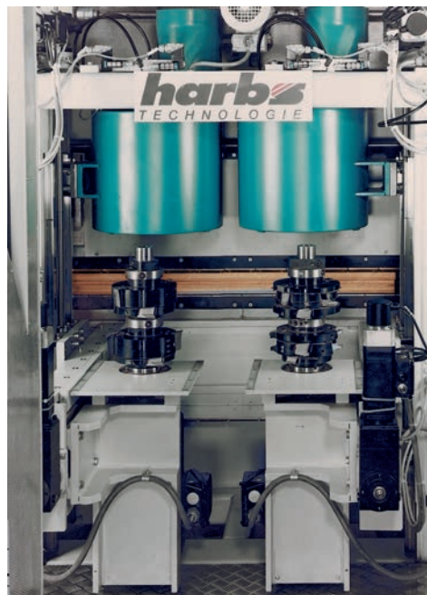
Absauganlagen. Späneabsaughauben für hoch bestückte Hubspindeln, frei zugänglichen Werkzeugwechsel, über vertikale Linearführung pneumatisch gehoben/gesenkt, doppelwandig ausgeführt. In den Wandungszwischenraum werden die Späne unter zusätzlicher Nutzung der Zerspanungsenergie mit Schlitzdüseneffekt eingesaugt und abgeführt, verbleibende frei fliegende Späne nach oben konventionell abgesaugt. Bild: Schwabedissen, Herford.
