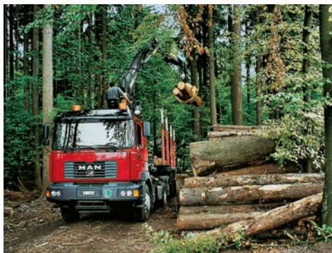
Abfuhr des Rohholzes. Sattelzug mit höhenverstellbaren Rungen und Bordkran. Bild: MAN.
