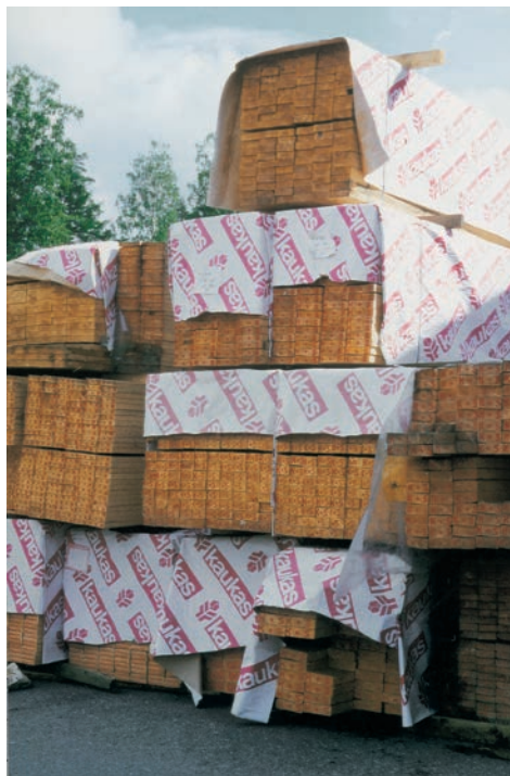
Abdecken der Schnittholzstapel, Bild 2. Schnittholzpakete mit Planen abgedeckt. In einem skandinavischen Sägewerk zum Versand bereitgestellt. Bild: T. Trübswetter.
