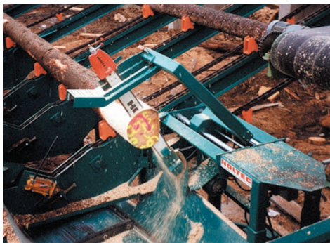
Abkappen, Bild 1: Vorkappen von schwachem Rundholz mit Schwertkettensäge. Bild: Holtec.
